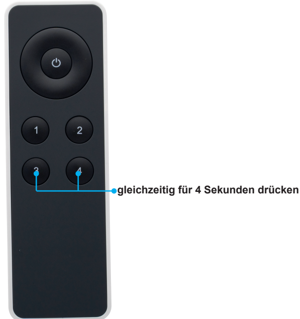
[Bild 9] Connect Mesh Eco Fernbedienung, Hinzufügen von weiteren Boxen
