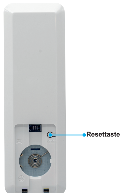
[Bild 8] Connect Mesh Eco Fernbedienung, Zurücksetzen
